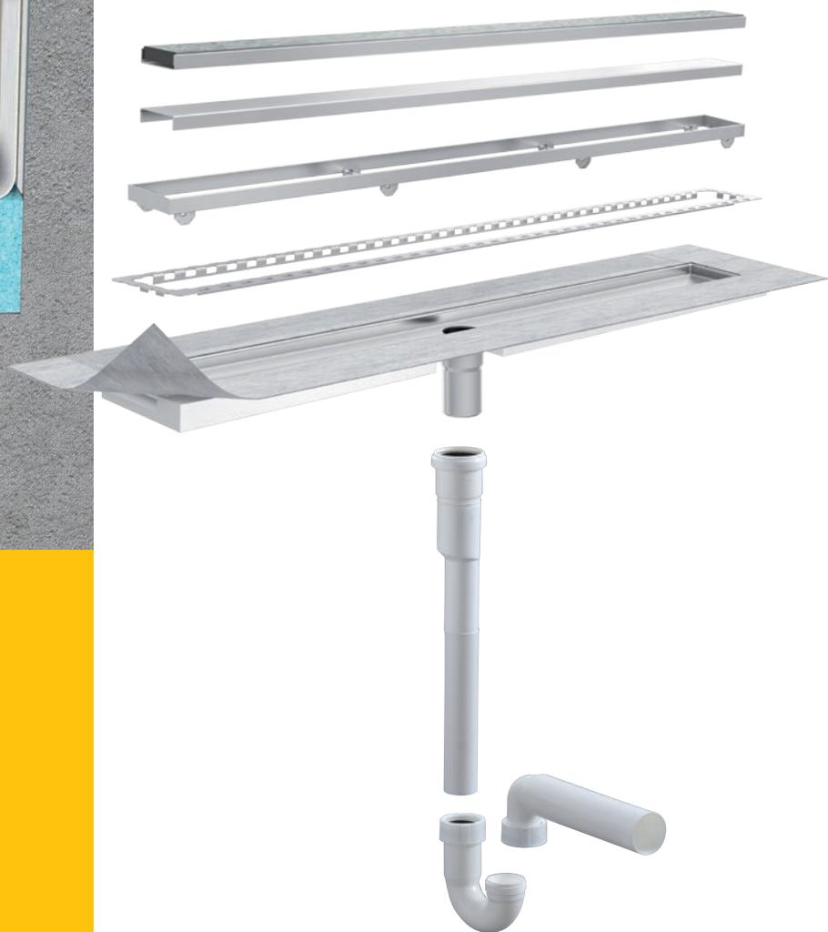
Oft fehlt der Platz für eine klassische Rohrverlegung. IndorTec® FLEXDRAIN-HD als Ausführung mit senkrechtem Bodenablauf kommt mit nur 28 mm Aufbauhöhe aus und wird inklusive Rinnenträger aus Polystyrol und Rohrsiphon geliefert. Das System ist daher ideal für den Einsatz in Erdgeschoss-Bädern oder auf Holzbalkendecken.
