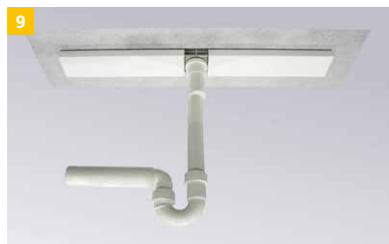
Für die Variante mit senkrechtem Abgang wird ein Röhrensiphon mitgeliefert. Das senkrechte Rohr ist vor dem Setzen der Rinne zu montieren und so durch die Decke zu führen.
