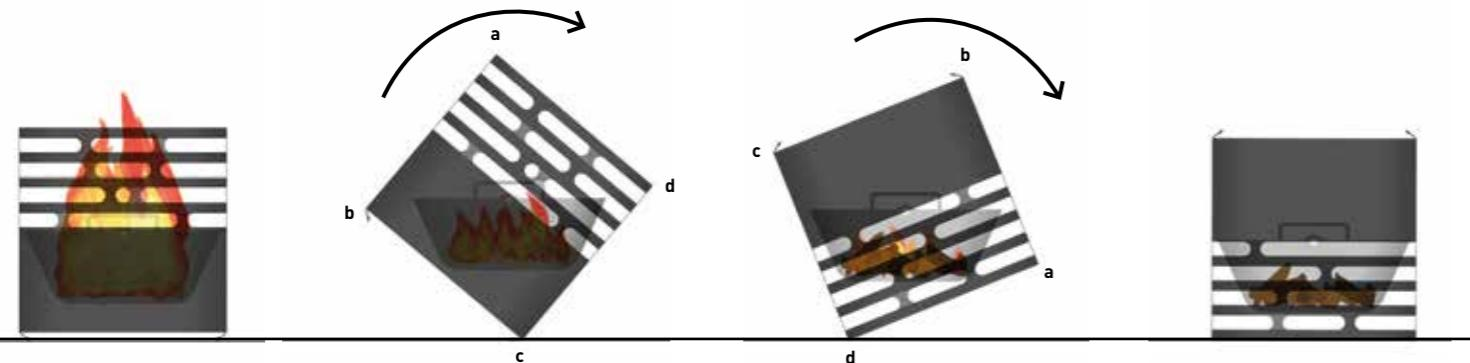
**⚠️** WICHTIG! CUBE darf nur um die Kanten mit Fuß (b und c) und um die Kanten mit Griffbereich (a und d) gekippt werden. Anders gesagt CUBE darf nur um Kannten gekippt werden, welche die gleiche Flucht haben wie die Lagerachse der Brennschale. ACHTUNG! Andernfalls, dreht sich die Brennschale mit, bleibt nicht im Lot stehen und Sie kippen den Feuerkorb aus.
